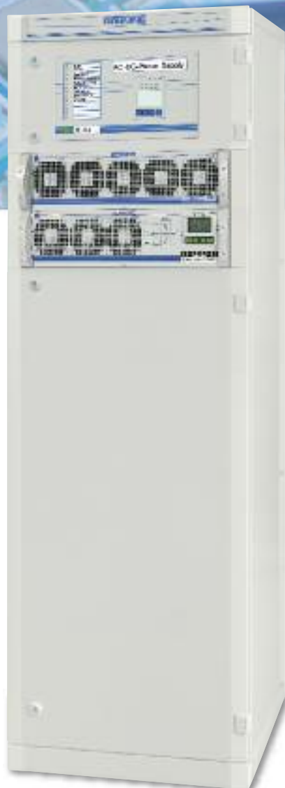
Rys. 8: Szafa systemowa prostownik - falownik wyposażona w 3 moduły falowników, układ EUE, ręczny układ obejściowy (moc wyjściowa 4,5 KVA) oraz 5 modułów prostowników, napięcie wyjściowe 220 V DC, prąd wyjściowy 50 A DC
