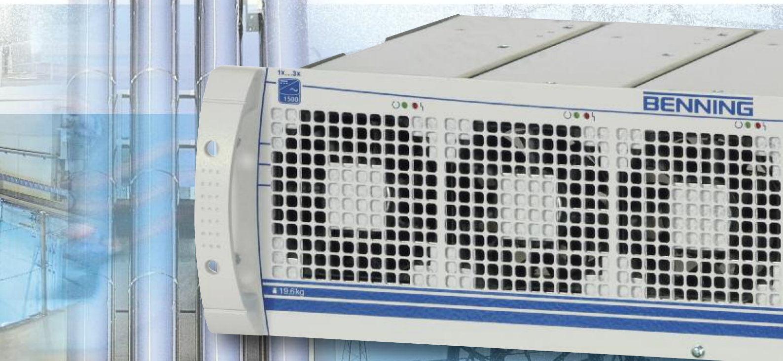
Рис. 5: 19" корзина с 3 инверторами, статическим байпасом и механическим байпасом, выходное напряжение 230 В, выходная мощность 4,5 кВА
