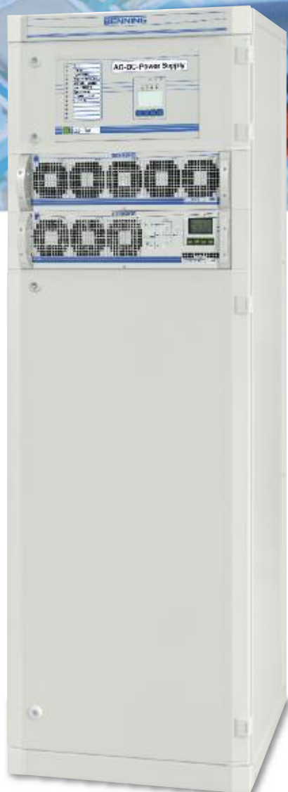
Рис. 8: Инверторно-выпрямительный шкаф с: 3 инверторными модулями, статическим и механическим байпасом Выходная мощность 4,5 кВА 5 выпрямительных модулей, выходное напряжение =220В, выходной ток =50А
