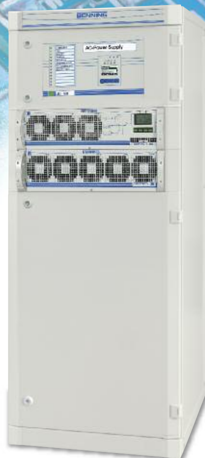
Рис. 7: Инверторный шкаф с 8 инверторными модулями, статическим и механическим байпасом. Выходная мощность системы 12 кВА
