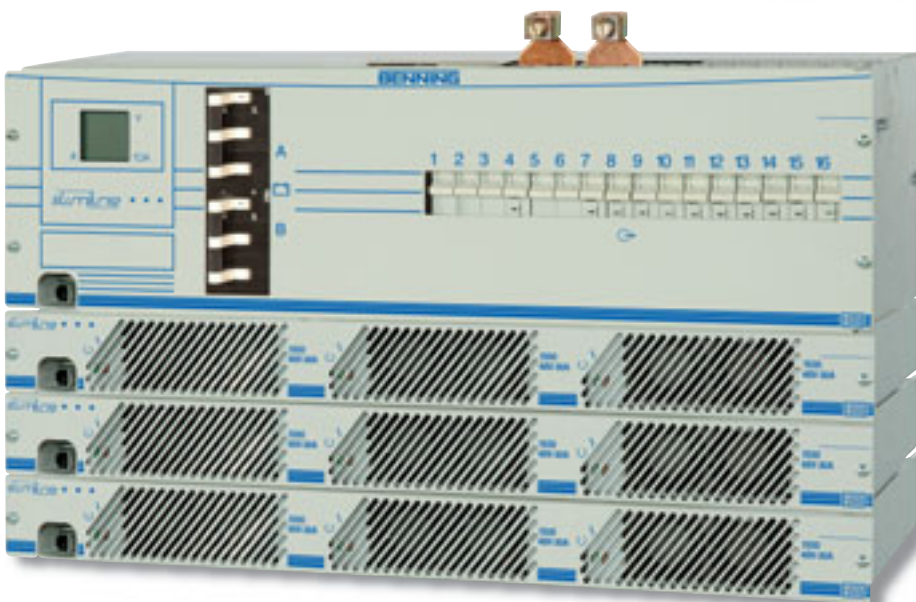
Figure 11 : Redresseur, distribution SMS13500 2 x Disjoncteur batterie 9 x 48V 1500W 16 x fusibles utilisation
