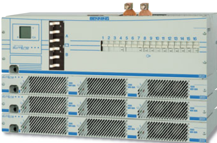
Obr. 11: Usměřovač, rozvaděč SMS 13500: 2 x jistič pro baterie 9 x 48 V - 1500 W 16 x jistič pro spotřebiče
