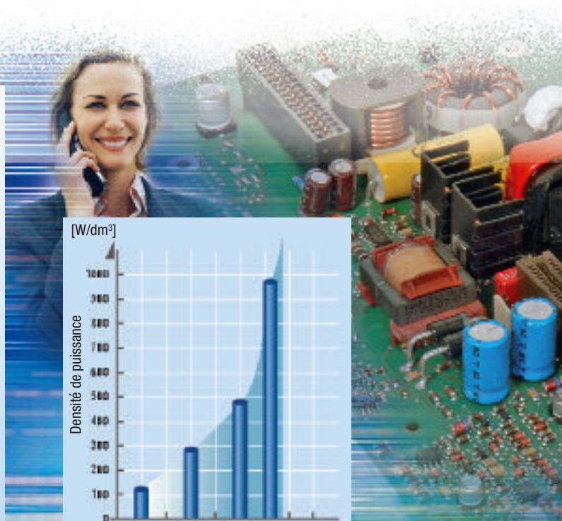
Graphique 1: Densité de puissance des modules monophasés 48V en télécommunication au cours des dernières décades
